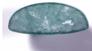
樹脂含浸処理されたジェイダイトの 切断面(樹脂が浸透した外縁部のみ濃色) 開示コメント*J3 又は*J4
