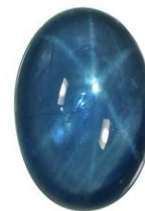
外部からの元素の拡散加熱処理による人為的なアステリズム
