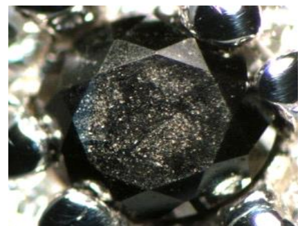
高温加熱処理によるブラック・ダイヤモンド 開示コメント※D2
